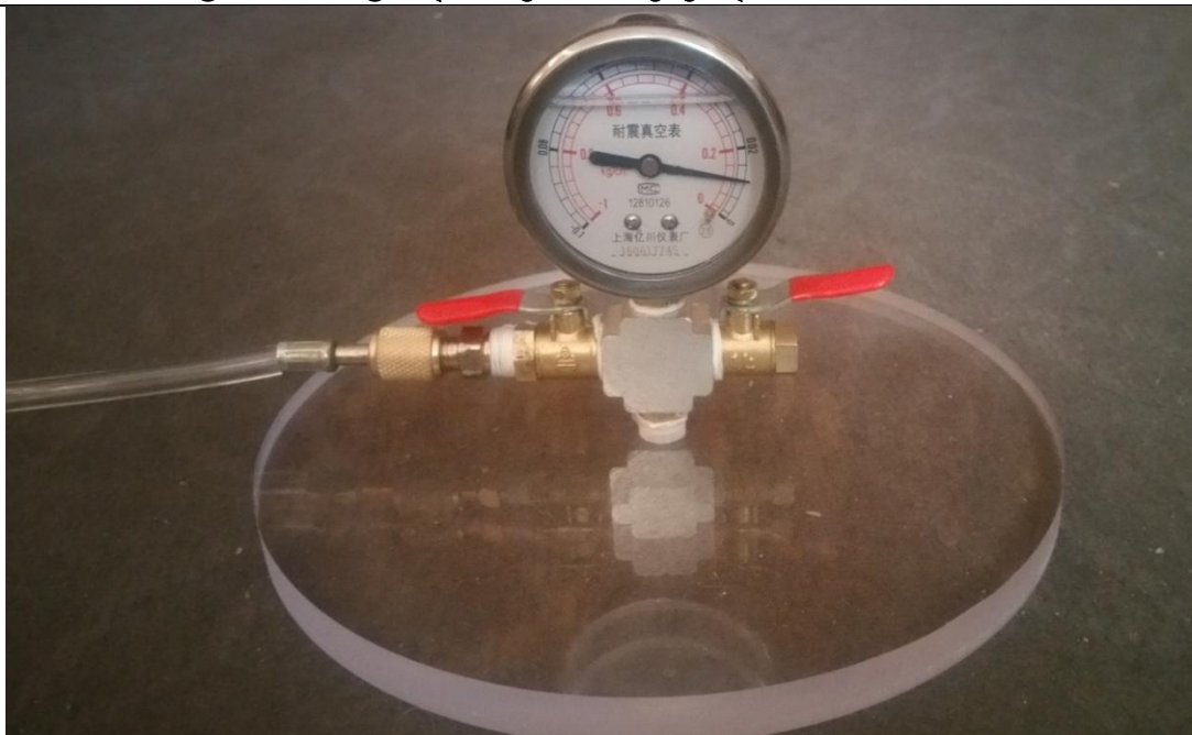
Рис. 3. Крышка с вмонтированным барометром.
